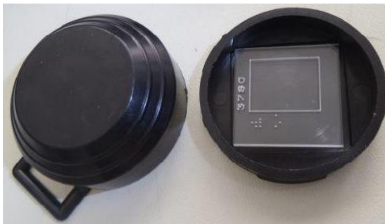
Figura 2: dosimetro di misurazione dell'attività radon indoor
