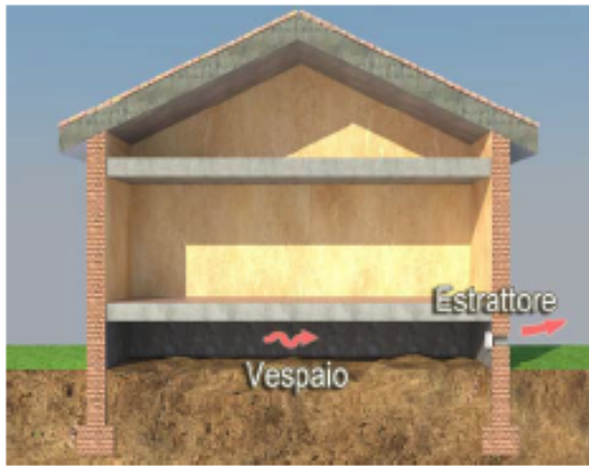
Schema dell'intervento di ventilazione forzata del vespaio.
