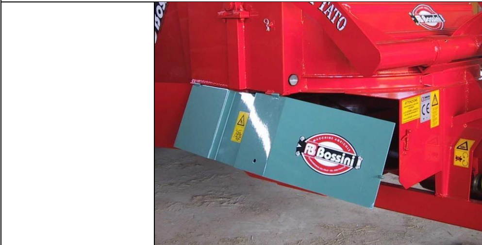
PROTEZIONE DELL'ORGANO SPANDITORE. RIPARO IN POSIZIONE DI CHIUSO QUANDO LA MACCHINA NON E' UTILIZZATA E IN POSIZIONE DI APERTO DURANTE LO SPANDIMENTO
